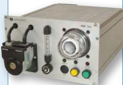
Dispozitiv de pregătire gaz de măsurare MGK 744 pentru eliminarea condensului și filtrarea gazului de măsurare.
